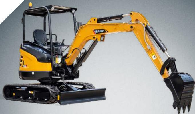
La maniabilité et la précision de la commande sont essentielles pour les travaux minutieux en zone urbaine ou les travaux paysagers. Ces caractéristiques associées à la grande puissance qu'il offre, font de la mini-excavatrice SY26C un outil puissant de grande qualité et un partenaire fiable.
